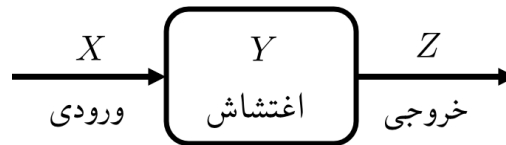
شکل ۱. یک سامانه خطی با ورودی X ، خروجی Z و اغتشاش جمعی Y
